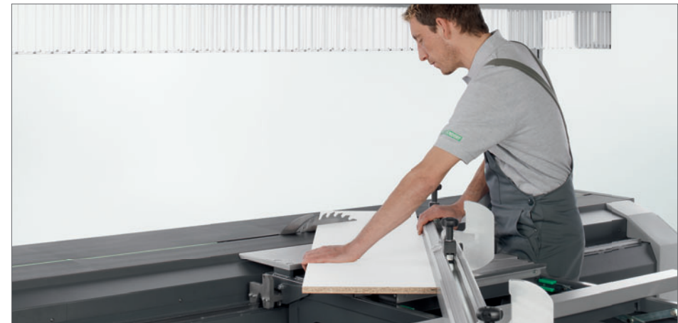
– Kanten- und Gehrungswinkel am Winkel-Gehrungsanschlag mit fixiertem Sägeaggregat
