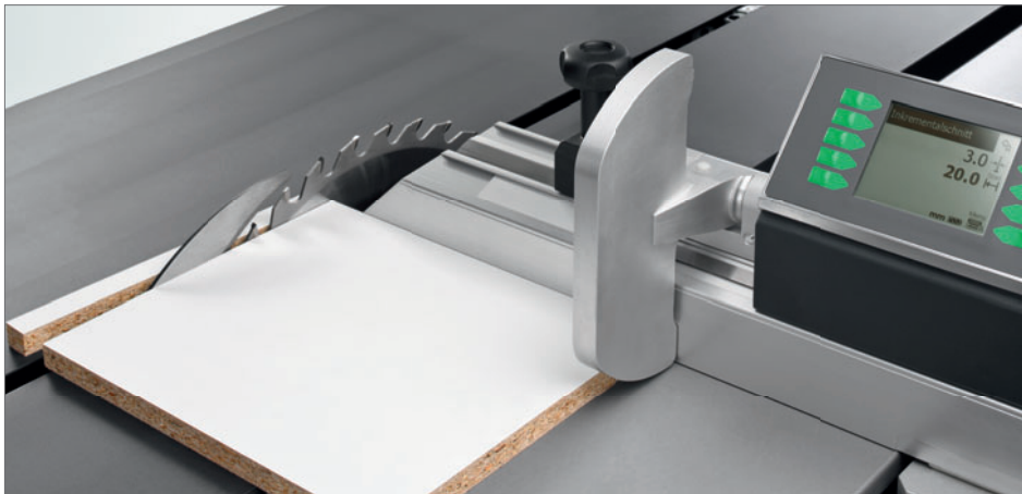
_ Ablängen am Winkel-Gehrungsanschlag – inkremental
