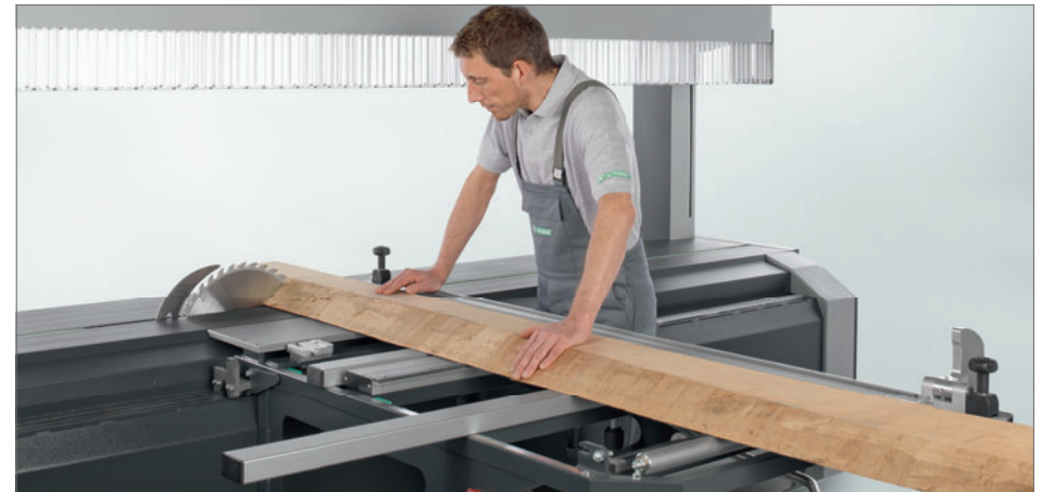
_ Ablängen mit fixiertem Sägeaggregat
