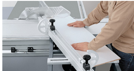
Mitre cut using crosscut-mitre fence.
