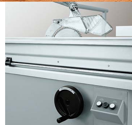
Regolazione manuale dell'altezza.
