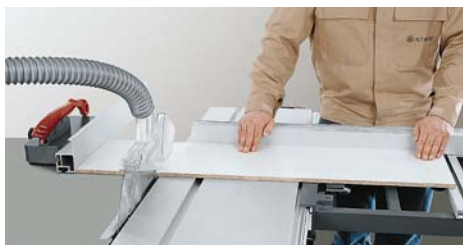
Tagliare le strisce di pannello fino alla lunghezza finale sul registro parallelo.
