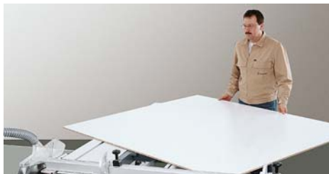
Ruotare il pannello in senso antiorario e accostare il bordo rifilato sul registro per taglio in squadra.
