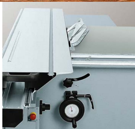
Regolazione manuale dell'inclinazione.
