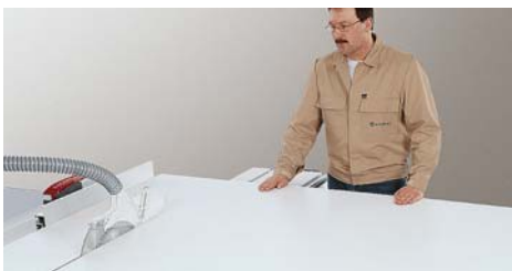
Tagliare strisce del pannello sul registro parallelo.
