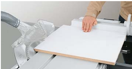
Inclinare la lama sull'angolo desiderato, accostare il pezzo in lavorazione sul registro per taglio in squadra obliquo.
