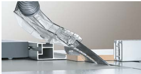
Taglio in squadra sul registro parallelo con pezzo in lavorazione sul carrello a doppi rulli.
