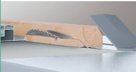
Het werkstuk onder de klem schoen bevestigen en afkanten.
