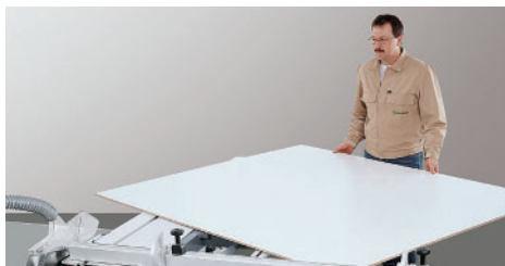
De plaat linksom draaien en de gekantrechte kant tegen de hoekaanslag leggen.
