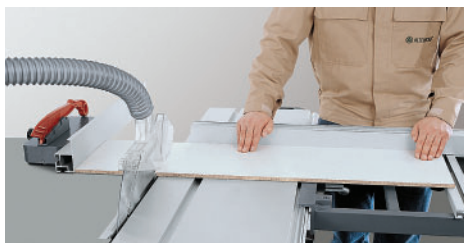
Stroken op de parallelaanslag op de uiteindelijke lengte zagen.
