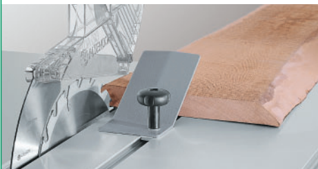
De klem schoen zet de plank vast op de dubbele-rolwagen.
