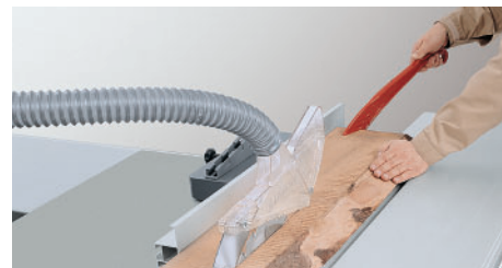
Het werkblad op de parallelaanslag door het roterende zaagblad leiden, eventueel met behulp van het dunhout.
