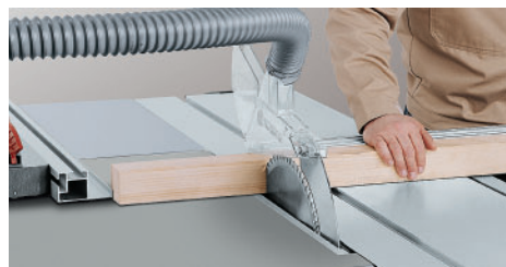
De parallelaanslag vóór het zaagblad plaatsen, op maat stellen en inkorten.
