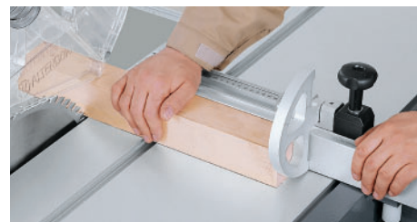
Het resterende deel wordt op de hoekaanslag op maat gezaagd.
