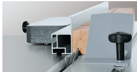
De zaaghoogte en op de parallelaanslag de breedte instellen.
