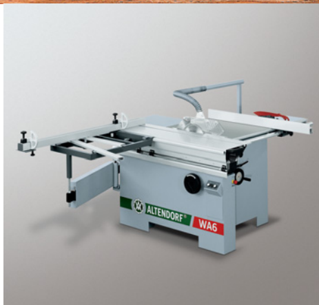
Укороченная двухроликовая каретка: по желанию заказчика возможна поставка каретки длиной 1600 мм.
