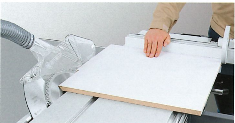
Das Sägeblatt auf das gewünschte Maß schwenken, das Werkstück am Winkel-Gehrungsanschlag anlegen.
