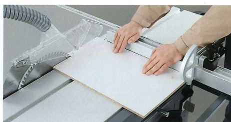
Das Reststück am Winkelanschlag auf Breitenmaß schneiden.
