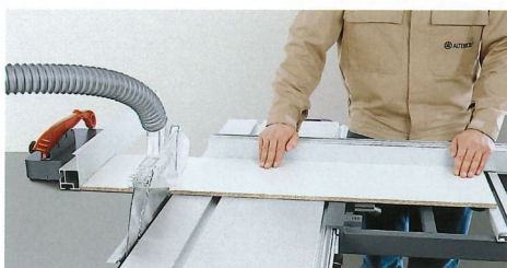
Plattenstreifen am Parallelanschlag auf Fertiglänge schneiden.
