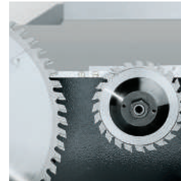
Vorritzer. Separater Vorritzermotor mit 0,37 kW und Ein/Aus-Schalter.
