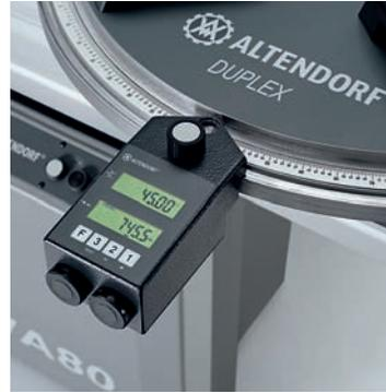
■ **DUPLEX DD.** DUPLEX DD è brevettato a livello internazionale. I vantaggi più evidenti di cui si avvale, sono l'eliminazione di complesse conversioni, di verifiche delle dimensioni e dei tagli di prova. L'unità elettronica di alta precisione è sviluppata in esclusiva dalla Altendorf, calcola la misura della lunghezza in funzione dell'angolo su entrambi i lati del registro, visualizzandola digitalmente. Tutti i DUPLEX possono essere posizionati liberamente su tutta la lunghezza del carrello.
