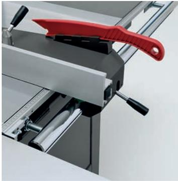
■ **Registro parallelo.** Il registro parallelo è scorrevole e di precisa regolazione. La barra cromata rende lo scorrimento più facile. Per il taglio di pannelli di grosse dimensioni, il registro può essere ribaltato sotto il piano.
