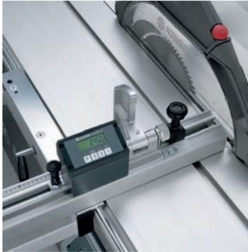
■ **Registro per tagli in squadra DIGIT L.** Questo registro è dotato di indicatore digitale della lunghezza con regolazione micrometrica che consente un'impostazione con una precisione di  $\pm 1/10$  mm. Il campo d'intestatura è compreso tra 150–3200 mm. La necessaria procedura di taratura, per esempio in caso di sostituzione della lama, è eseguibile in tempi rapidi, è costantemente in funzione e quindi sempre disponibile.
