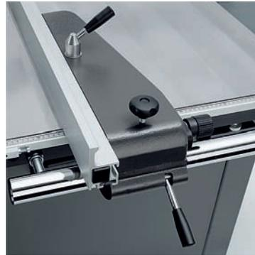
■ **Registro parallelo con regolazione micrometrica manuale.** La regolazione micrometrica manuale consente una precisa impostazione del registro parallelo. Il registro può essere impostato al millimetro tramite la vite di regolazione.
