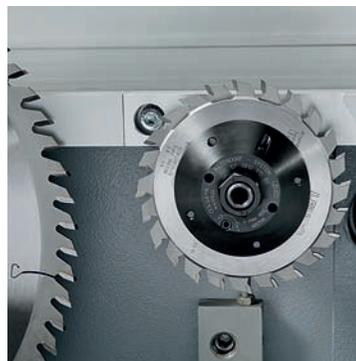
■ **Подрезатель (опция).** При раскрое облицованных плит подрезатель позволяет избежать сколов с нижней стороны. Регулировка по вертикали и горизонтали осуществляется вручную. После настройки высоты подрезатель может быстро опускаться с помощью рычага. Настроенная высота может использоваться повторно посредством возврата рычага в верхнее положение. Подрезной агрегат оснащен приводом мощностью 0,75 кВт при 8 200 об/мин.
