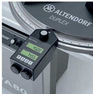
■ DUPLEX DD. DUPLEX DD запатентован нами во всем мире. Существенные преимущества: не требуются отнимающие много времени расчеты, дополнительные замеры и пробные пропилы. Разработанный конструкторами «Altendorf» прецизионный электронный блок упора DUPLEX DD производит расчет длины раскроя в зависимости от угла пропила по обе стороны от упора и индикацию обоих параметров на цифровом дисплее. Все варианты упоров DUPLEX могут без каких-либо затруднений позиционироваться по всей длине каретки.
