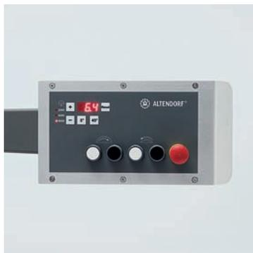
■ **Панель управления на уровне глаз.** Панель позволяет Вам постоянно следить за всеми основными функциями управления. Панель легко поворачивается и доступна с любой позиции оператора, как слева, так и справа от пильного диска.
