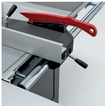
■ **Продольный упор.** Продольный упор отличается легкостью хода и точностью регулировки. Легкость хода упора обеспечивается системой твердохромированных штанг круглого сечения. При раскрое крупногабаритных плит упор может быть при помощи рукоятки опущен ниже уровня стола.
