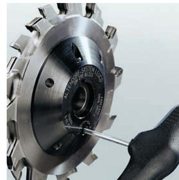
■ **Подрезатель системы RAPIDO.** RAPIDO облегчает и ускоряет регулировку ширины пропила подрезателя. Продолжительность: максимум три минуты. По сравнению с традиционными подрезателями Вы экономите до 30 минут времени на настройку, поскольку не требуется утомительный монтаж двухэлементных подрезных дисков с распорными кольцами. Ширина пропила может без демонтажа бесступенчато настраиваться на ширину пропила и основного пильного диска. Диапазон регулирования: 2,8–3,8 мм.
