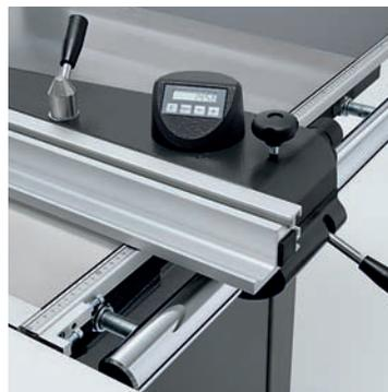
■ **DIGIT X.** Цифровая индикация размеров по ширине раскроя для продольного упора с тонкой ручной настройкой. Данная электронная измерительная система гарантирует точную и быструю настройку продольного упора. Повторяемые параметры могут в точности воспроизводиться и считываться на дисплее системы DIGIT X. Система не подвержена износу и не чувствительна к пыли. При переворачивании упорной линейки из положения плашмя на ребро или наоборот производится автоматическая корректировка размеров.
