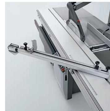
■ **Односторонний поперечный упор.** Односторонний поперечный упор обеспечивает возможность прецизионной резки под прямым и непрямым плоским углом. Легко настраиваемый упор может всего лишь несколькими движениями руки позиционироваться на двухроликовой каретке.
