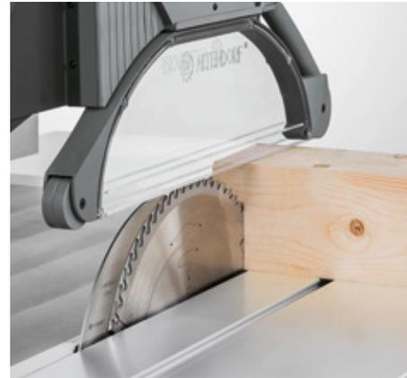
■ **Sägeblattüberstand:** Der Sägeblattüberstand der WA 80 beträgt 150 mm (Sägeblattdurchmesser 450 mm). Somit erreichen Sie sowohl beim Ablängen und Formatieren als auch bei geschwenktem Sägeblatt eine größere Schnitthöhe.
