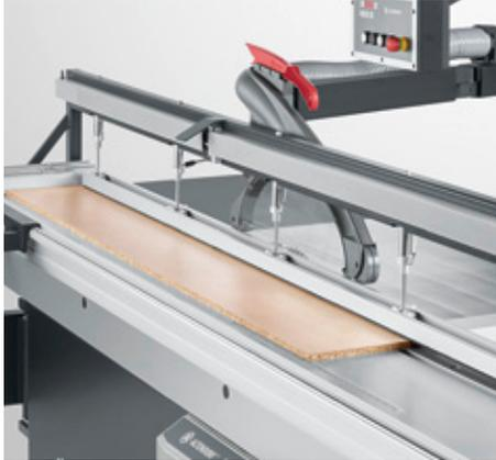
■ **Pneumatischer Druckbalken:** Ideal zum sicheren Spannen von Werkstücken bis 80 mm Dicke und deshalb besonders vorteilhaft bei langen und dünnen Materialien. Der Druckbalken ist zweigeteilt und getrennt steuerbar. Benötigt Pneumatikanschluss mit 6 bar.
