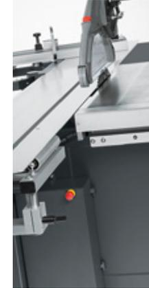
■ **Vordere Auflagerolle:** Die vordere Auflagerolle ist mit einer Breite von 300 mm beim Schneiden langer Werkstücke am Parallelanschlag eine hilfreiche Unterstützung. Sie kann mit einem Handgriff um 90° unter den Doppelrollwagen (Mindestlänge 3 000 mm) positioniert werden.
