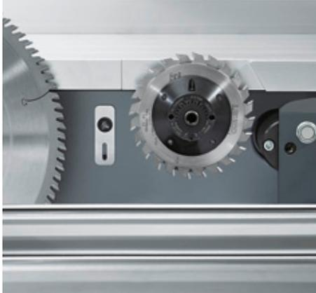
■ **Elektromotorischer Vorritzer:** Der Vorritzer ermöglicht ausrissfreie Unterseiten beim Sägen von beschichtetem Plattenmaterial. Die Höhenverstellung erfolgt elektromotorisch, die Seitenverstellung manuell. Mit Einschalten des Vorritzsägeblatts fährt der Vorritzer automatisch auf die Arbeitsposition bzw. beim Ausschalten zurück unter die Tischplatte. Das Vorritzaggregat hat eine Antriebsleistung von 0,75kW bei 8200U/min.
