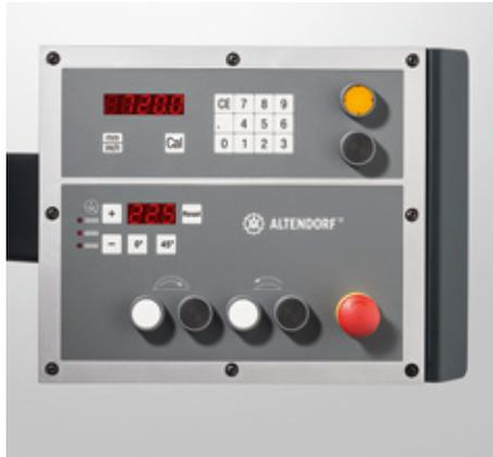
■ **Bedienpaneel in Augenhöhe:** Hier haben Sie alle zentralen Steuerungsfunktionen immer im Blick. Es ist schwenkbar und von allen Seiten leicht zugänglich. Das Sägeblatt und der Parallelanschlag sind elektromotorisch verstellbar.
