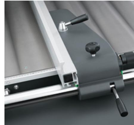
■ **Parallelanschlag mit manueller Feineinstellung:** Der Parallelanschlag ist leichtgängig und präzise verstellbar. Seine Leichtgängigkeit erhält der Anschlag über das hart verchromte Rundstangensystem. Sollen große Platten aufgeteilt werden, kann er mit einem Griff unter die Tischebene geschwenkt werden. Es kann eine Schnittbreite von 800, 1000 oder 1300 mm gewählt werden.
