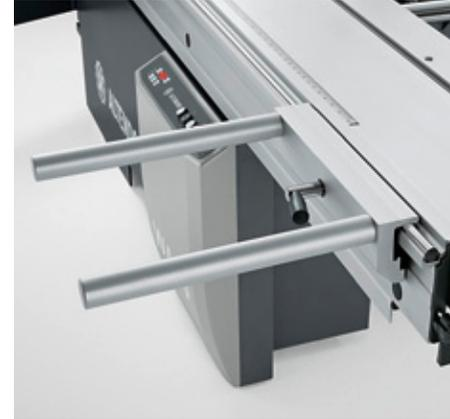
■ **STEG – zweite Auflage am Doppelrollwagen:** Vergrößerte Auflagefläche (Breite 400 mm) für breitere Werkstücke. Entlastet den Bediener beim Formatieren großer Plattenwerkstoffe.
