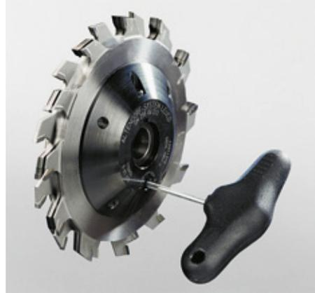
■ **RAPIDO Vorritzwerkzeug:** Der RAPIDO erleichtert und beschleunigt die Schnittbreitenverstellung. Dauer max. drei Minuten. Gegenüber herkömmlichen Vorritzsystemen sparen Sie mindestens zehn Minuten Einstellzeit, da das mühsame Montieren von zweigeteilten Vorritzblättern mit Distanzscheiben entfällt. Die Schnittbreite des Vorritzblattes kann ohne Demontage stufenlos auf die Schnittbreite des Hauptsägeblatts eingestellt werden. Einstellbereich: 2,8–3,8 mm,  $\varnothing = 120$  mm.
