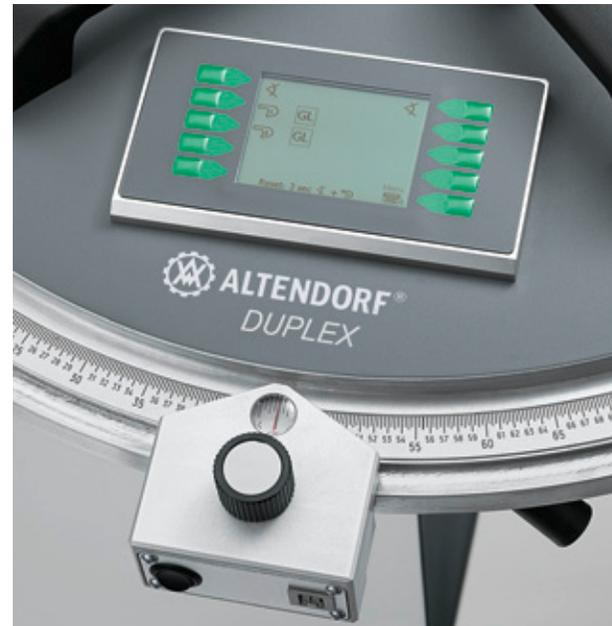
■ **DUPLEX DD:** Der DUPLEX DD ist weltweit patentiert. Die großen Vorteile: Aufwendiges Umrechnen und Nachmessen sowie Probeschnitte entfallen. Die exklusiv von Altendorf entwickelte, hochpräzise elektronische Einheit des DUPLEX DD errechnet das Längenmaß in Abhängigkeit zum Gehrungswinkel auf beiden Seiten des Anschlags und zeigt beide Werte digital an. Ermöglicht das Ablängen bis 1350 oder 2150 mm.
