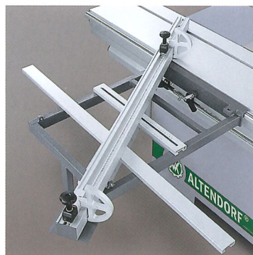
Winkel-Gehrungsanschlag: Für präzises Schneiden von Winkeln und Gehrungen in einer Funktion. Ablängbereich: 105–2600 mm. Schwenkwinkel stufenlos einstellbar von 0–49°.
