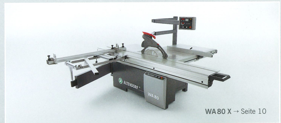
Altendorf WA 80 X mit elektromotorischer Höhen- und Schwenkverstellung des Hauptsägeblatts und elektromotorischer Verstellung des Parallelanschlags.
