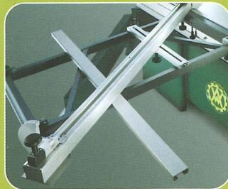
Winkel-Gehrungsanschlag: Für präzises Schneiden von Winkeln und Gehrungen in einer Funktion. Ablängbereich: 95 – 3200 mm. Schwenkwinkel stufenlos einstellbar von 0 – 49°.
