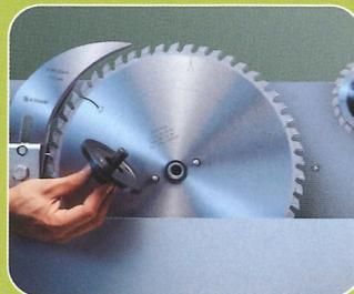
Vorritzer mit Schnellabsenkung und mechanischem Höhenspeicher:
