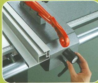
Die Feineinstellung am Parallelanschlag, präzise und leichtgängig.
