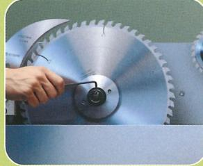
*Schneller, komfortabler Sägeblattwechsel durch das Schnellspann-System.*
