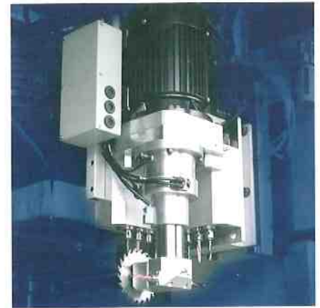
Das Bohraggregat verfügt über 9 vertikale Spindeln. Eine Nutsäge mit horizontalem Bohrgetriebe ist optional erhältlich.
