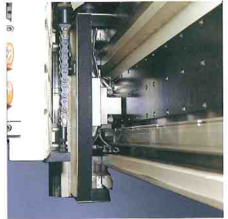
Linearantriebe sind besonders gut für HSC-Bearbeitungen geeignet.
