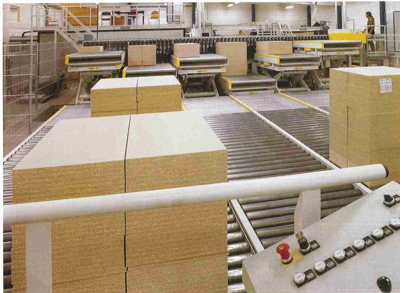
Halbautomatische Rechenabstapelung mit 6 Stationen. Semi-automatic fork-destacking system with 6 stations.
