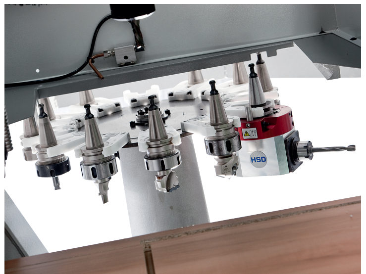
Cambio utensile a 12 posizioni sul carro X 12 positions tool changer on X carriage
