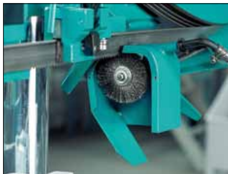
Hydraulisch angetriebene Spänebürste zur Sägebandreinigung
