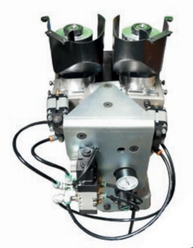
Optimale Verleimung durch die Kontrolle des Temperaturunterschieds zwischen Leimbehälter und Leimauftragwalze. Eine automatische Vorrichtung vermeidet, dass der Leim überhitzt, wenn die Maschine nicht verwendet wird. Einfache und schnelle Wartung durch die Innenbeschichtung aus Teflon. Automatische Schneidvorrichtung für 3 mm dicke Kanten.
