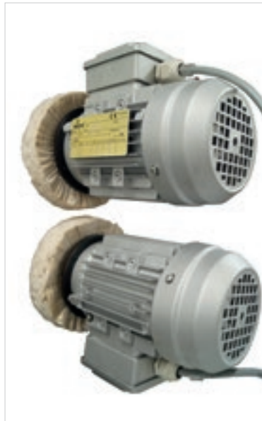
Bürstenaggregat zum Reinigen und Polieren der Kante und der Platte.
