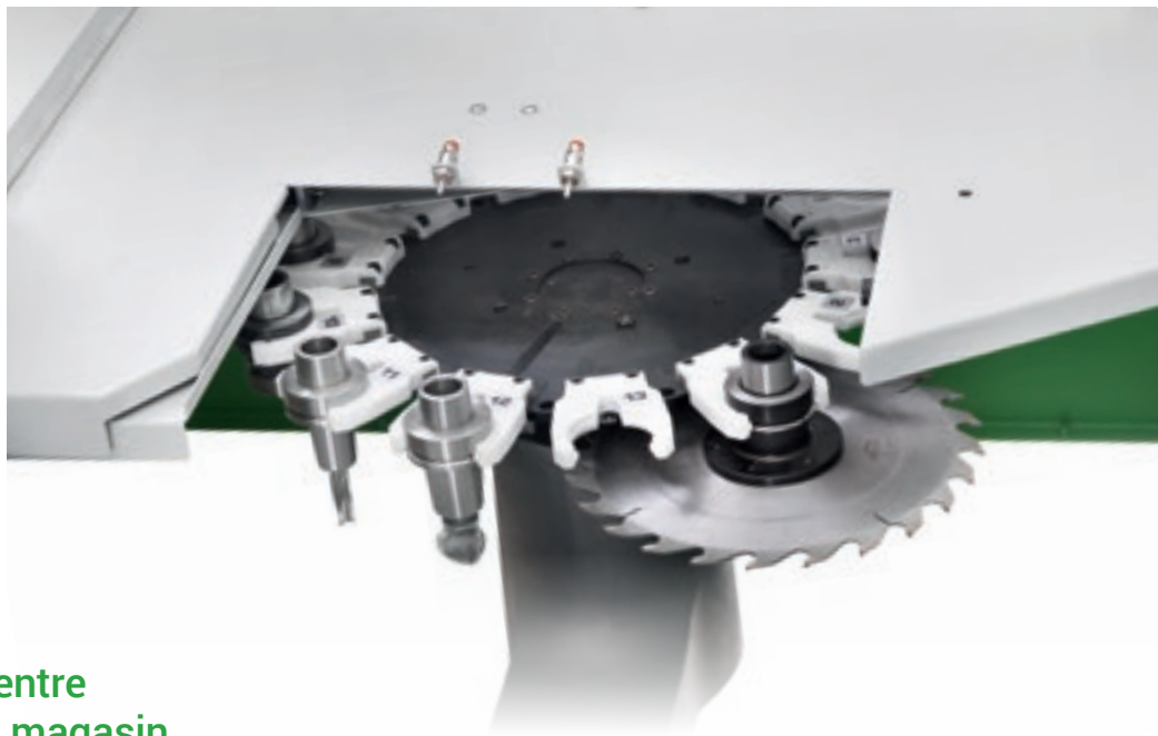
Magasin outils à râtelier 12/23 positions avec pick-up intégré.
