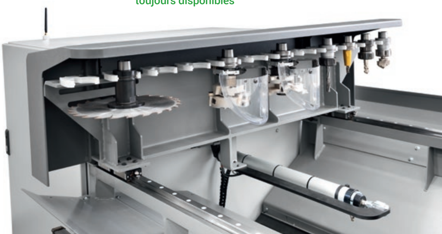
Magasin outils à râtelier 12/23 positions avec pick-up intégré.
