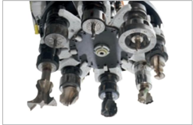
Jusqu'à 32 outils et agrégats disponibles dans la machine sans besoin de l'opérateur pour passer d'un façonnage à l'autre.
