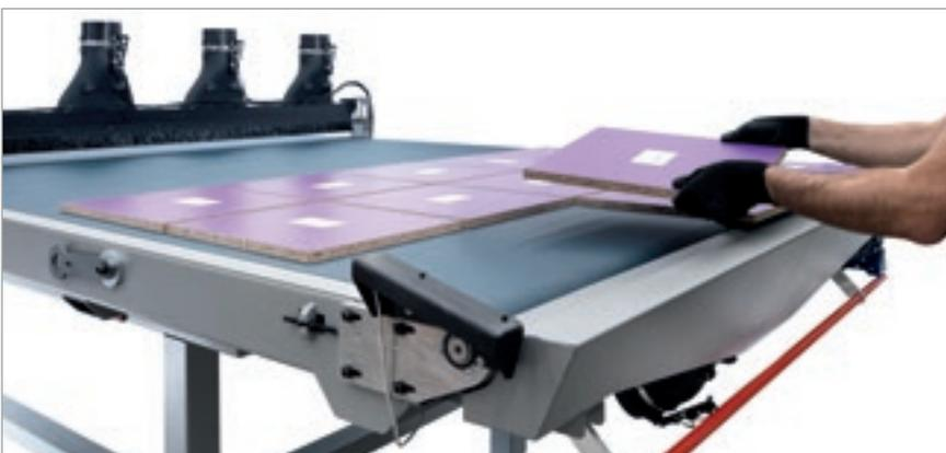
Temps d'arrêt machine considérablement réduits grâce au **tapis de déchargement** qui permet de décharger les panneaux usinés hors de la zone de façonnage de la machine.
