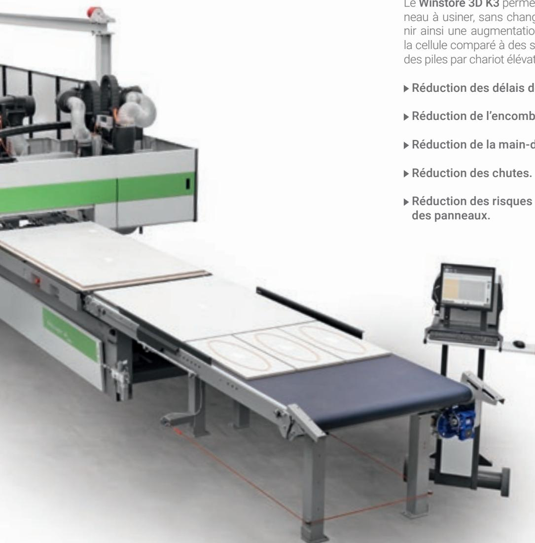
Le **Winstore 3D K3** permet de disposer à tout moment du panneau à usiner, sans changements de pile fréquents, et d'obtenir ainsi une augmentation considérable de la productivité de la cellule comparé à des solutions qui prévoient le chargement des piles par chariot élévateur.
