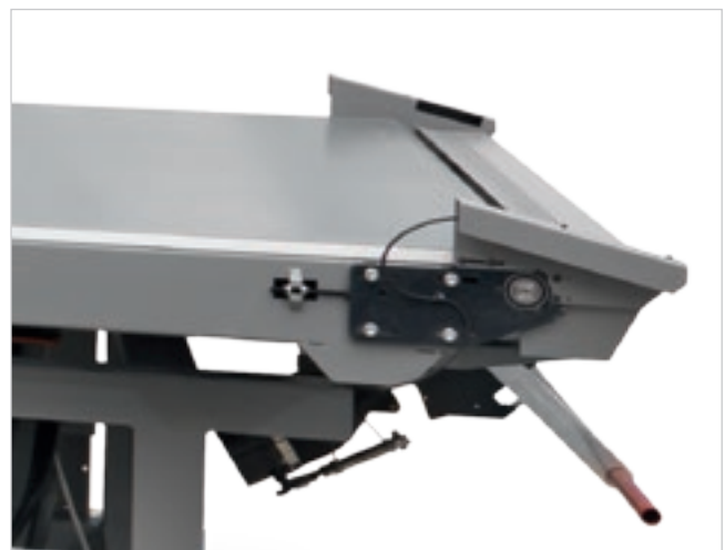
Kit complémentaire d'aspiration pour tapis de déchargement composé de 2 coiffes d'aspiration, l'une placée sur la partie supérieure du tapis de déchargement, l'autre située au bout du tapis.
