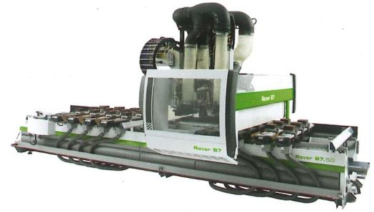
Rover B ist mit einer leistungsstarken numerischen Steuerung mit Multitask-Funktionen ausgestattet. Das exklusive Mechatrolink-System für die digitale Verwaltung der Achsen gewährleistet Präzision und Zuverlässigkeit, wodurch die für Analogsysteme typischen Interferenzen vermieden werden.
