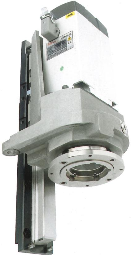
Die Multifunktionsgruppe kann Aggregate für spezifische Bearbeitungen (Aussparungen für Schlosser, Scharniersitze, tiefe Horizontalbohrungen, Kappen, usw.) aufnehmen. Je nach Bedarf kann zwischen einer Gruppe mit starrer Position, einer von 0°-90° schwenkbaren, einer von 0°-180° kippbaren oder einer stufenlos über NC um 360° verstellbaren Gruppe gewählt werden.
