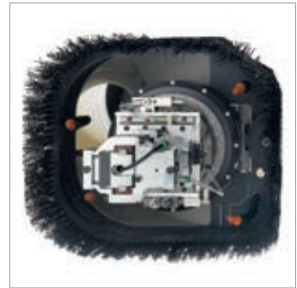
Abblaseinheit mit 4 Ausgängen, auch mit den Aggregaten für die Feinbearbeitung der Kante verwendbar.
