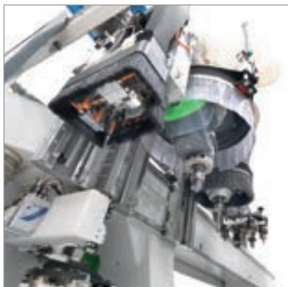
Vertikale Fräseinheit von 6 kW.
