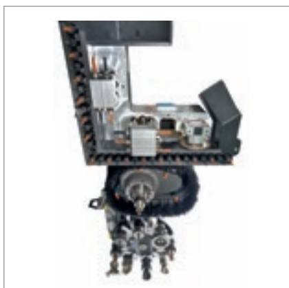
Unità di fresatura orizzontale a 1 uscita.
