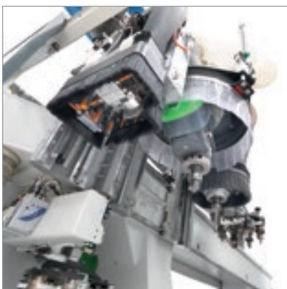
Unità di fresatura verticale da 6 kW.
