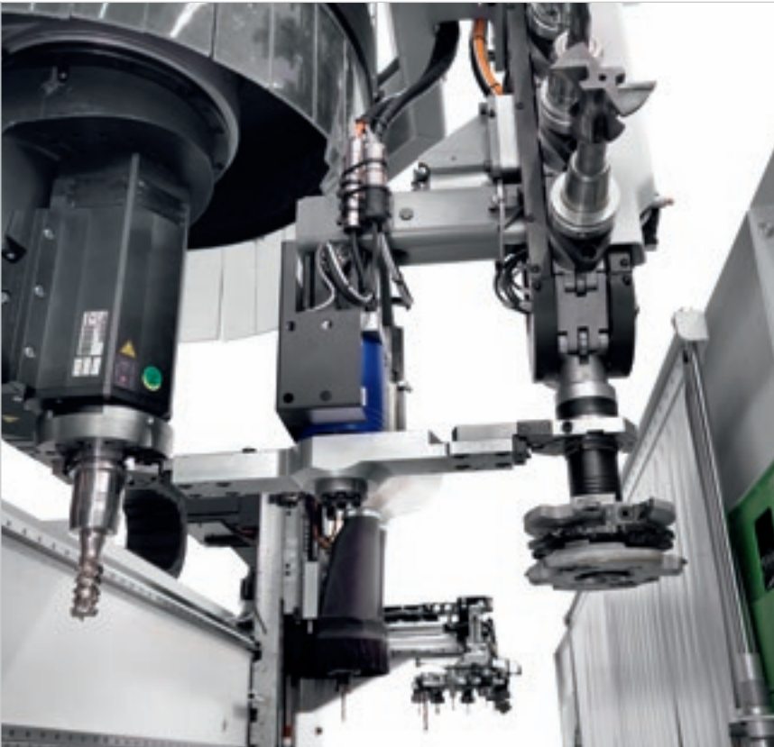
Senkrecht Kettens-Werkzeugmagazin auf Y-Achse mit 10-15 Positionen.
