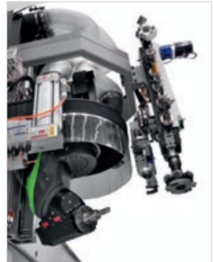
Senkrecht Kettens-Werkzeugmagazin auf Y-Achse mit 10-15 Positionen.
