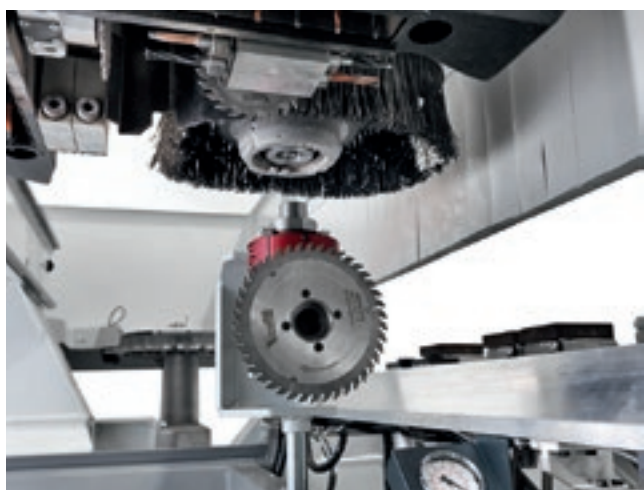
Il Pick Up permette di attrezzare i magazzini a bordo macchina.
