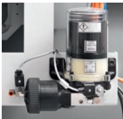
Lubrificazione automatica unità di foratura BHZ 29 2L.
