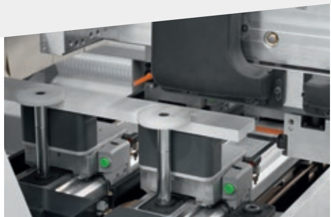
Sistema di bloccaggio Easyclamp per lavorazioni di pezzi stretti.
