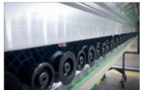
El Presor de correa, estándar de serie en la Stream A, permite al tablero pasar sobre la cinta garantizando una presión uniforme ideal hasta para los revestimientos más delicados.
