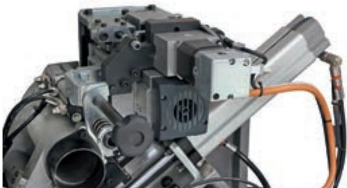
L'axe contrôlé, de série sur les deux versions du groupe arrondisseur, permet de gérer une multitude de positionnements de façonnage. La machine s'adapte parfaitement aux exigences de production.
