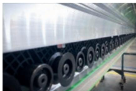
Il Pressore a Cinghia applica una pressione uniforme sulla superficie del pannello ideale per pannelli delicati o con pellicole protettive. Ottima tenuta con pannelli di dimensioni minime.
