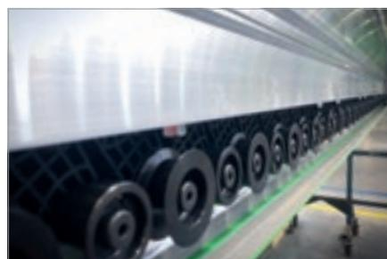
O pressor de Correia aplica uma pressão uniforme sobre a superfície do painel, ideal para painéis delicados ou com películas de proteção.
