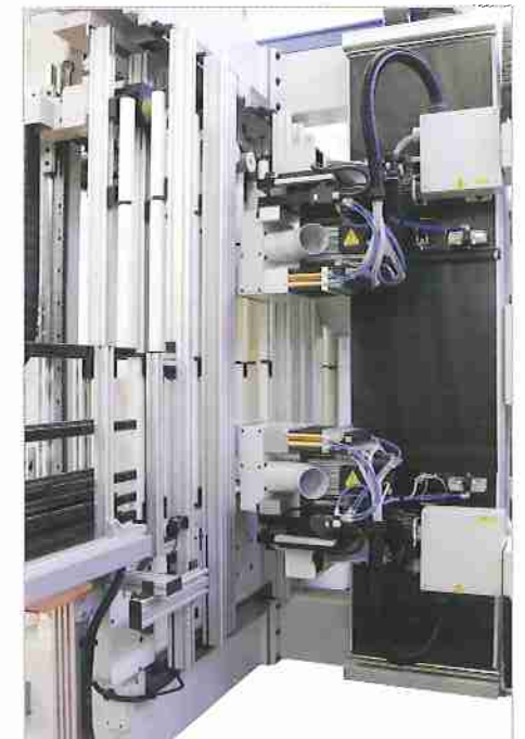
Ständerhinterseite ausgerüstet mit 2 Bohraggregaten, mit einzeln abrufbaren Bohrspindeln.
