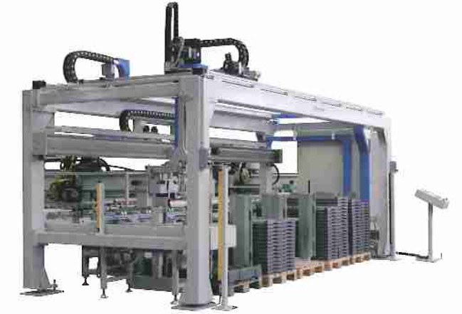
Zuführung für Schienen, von standardisierten Boxen auf Paletten, über ein Tablettssystem.
