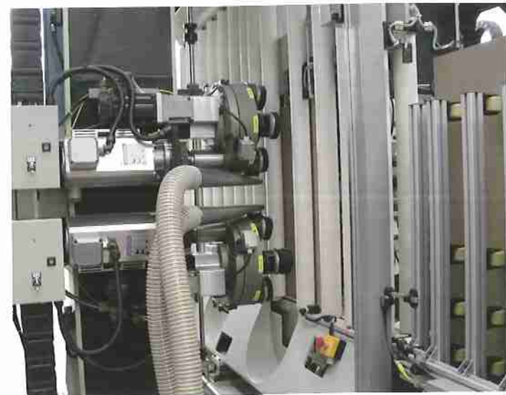
Seitenansicht mit zwei Revolveraggregaten, für das gleichzeitige Bearbeiten der linken Seite einer Türe. Detailed side machine view with double revolver unit for simultaneous processing on the left face of the door.
