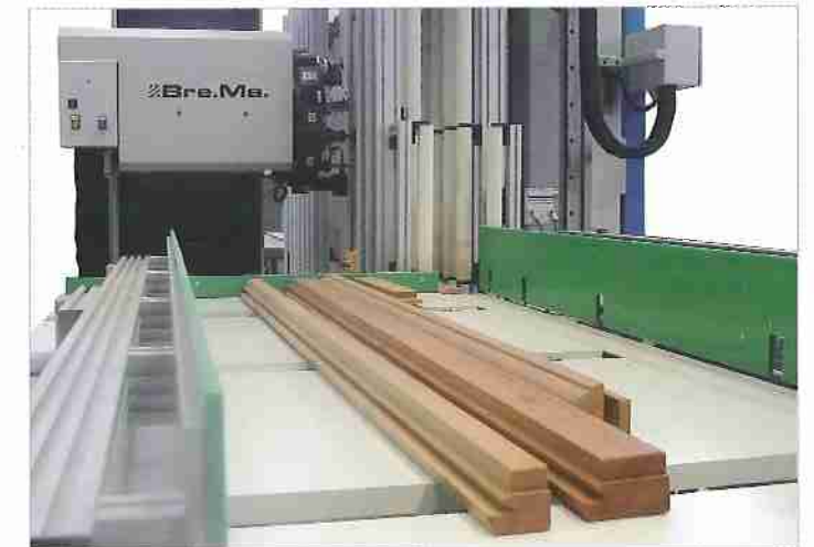
Detail der Zufereinheit für eine Maschine Mod. Vektor, ausgelegt für Fenster- und Türrahmen.
