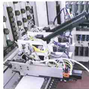
Einpressaggregat zu BLUM-Bänder f. Auszüge.
