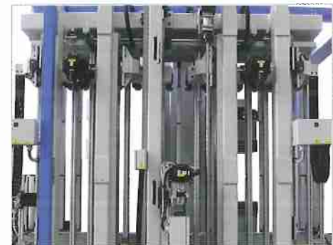
Gegenüberliegende Seite, ausgerüstet mit einem Sägeaggregat und Bohrspindeln einzeln abrufbar.
