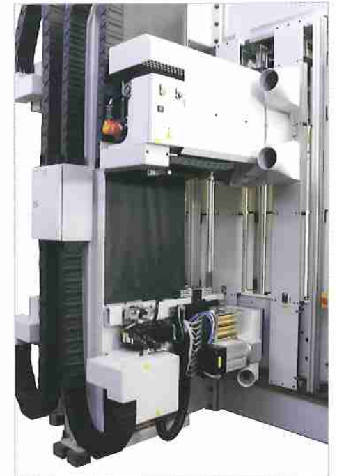
Ständervorderseite der Maschine, mit Bohraggregat mit einzeln abrufbaren Bohrspindeln und 10-fach Revolveraggregat.
