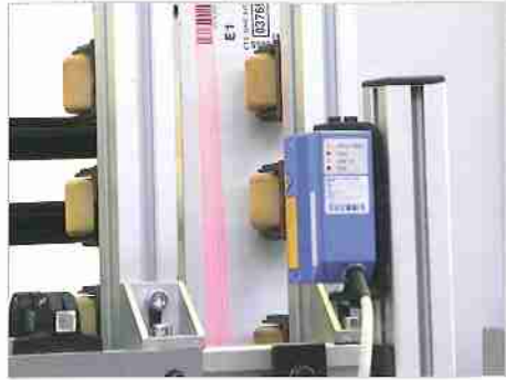
Detail des Lesevorgangs eines Barcodes auf dem Werkstück, beim Einlauf in die Maschine.
