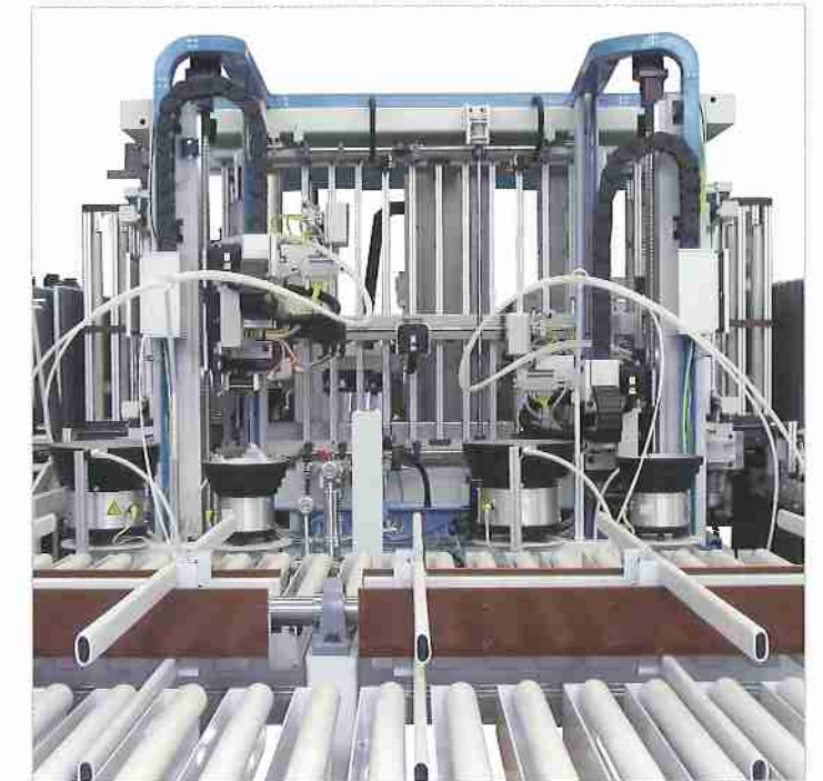
Seitenansicht der Maschine mit Bohr-, Beileim- und Dübeleinheiten.
