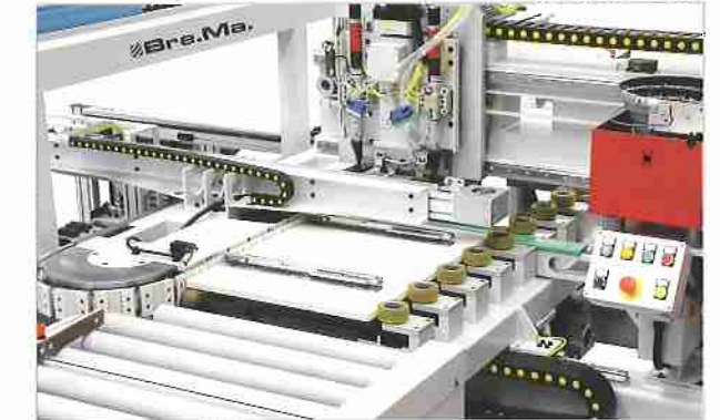
Detail – MIG Maschine zum Setzen von Auszugsschienen.
