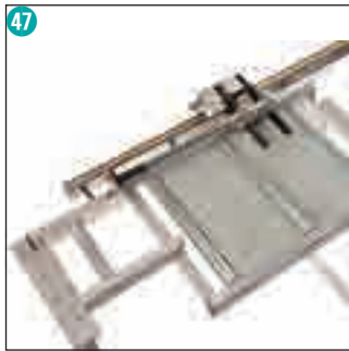
47 Längenschlag LM 55 M Arm und Federdämpfung (Option)
