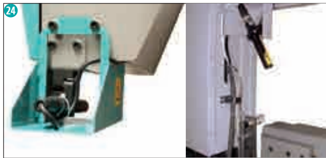
Laser zum Sägen auf Anriss
