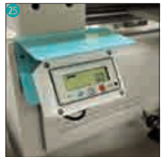
Digitale Anzeige der Gehrungseinstellung
