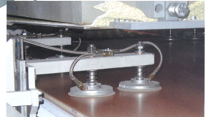
4 Pressenentleerung durch schwenkbare Vakuumsauger 4 Unloading of the press by swivelling the vacuum cups
