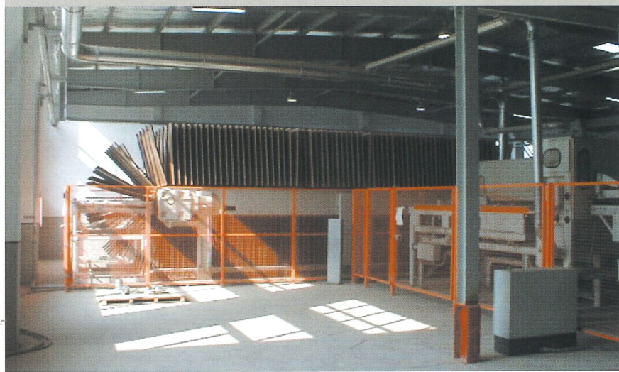
Kühlstern zum Abkühlen der beschichteten Platten
