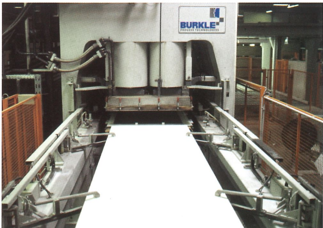
3 Pressenbeschickungssystem für 180 Takte pro Stunde 3 Press loading system for 180 cycles per hour
