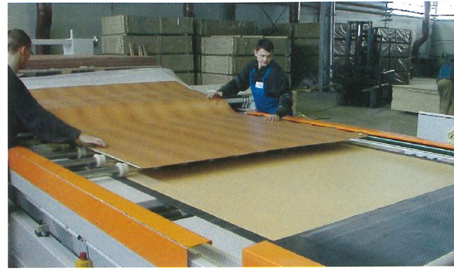
2 Plattenlegevorrichtung: Automatische Plattenlegevorrichtung und manuelles Legen des Melamin-papieres 2 Lay-up device: Automatic board lay-up device and manual laying-up of the melamine paper
