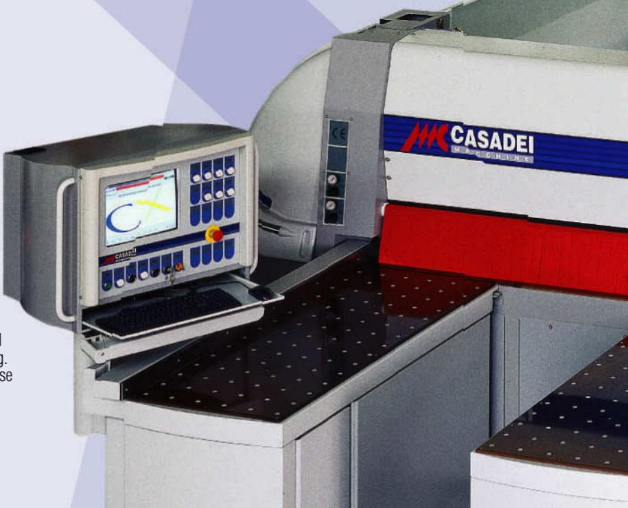
Il piano macchina è ricoperto da una speciale lamina di materiale antiraffigio. La robusta guida a quadro anteriore in acciaio, garantisce il massimo della precisione nella squadratura dei pannelli.
