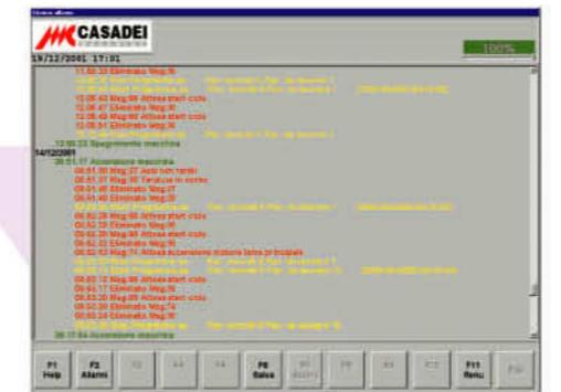
Un completo sistema di messaggi permette di segnalare all'operatore tutti gli eventi macchina. I messaggi sono memorizzati permettendo di avere uno storico delle lavorazioni della sezionatrice.
