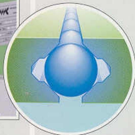
Rolltisch aus Leichtlegierung in eloxiertem Stahl, um eine Schwärzung der Werkstückoberfläche zu vermeiden, auf Stahlunterwagen mit induktionsgehärteten Prismenführungen: höchste Laufpräzision, Verschleissfestigkeit. Das Laufsystem hat einen begrenzten Kontaktpunkt mit erhöhter Kugelbelastung, wodurch die Führungen ständig sauber gehalten werden. Genauigkeit, leichter Lauf und ohne Wartung, das sind die Eigenschaften des seit über 20 Jahre bewährten CASADEI-Rolltisches.
