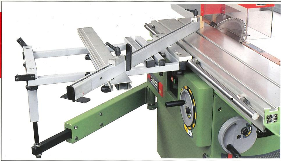
La guida telescopica in alluminio anodizzato può essere facilmente inclinata  $\pm 45^\circ$ . È inoltre possibile eseguire tagli inclinati combinati inclinando sia il gruppo sega che la guida telescopica, ciò conferisce estrema versatilità alla macchina e la rende ideale per qualsiasi tipo di esigenza produttiva.
