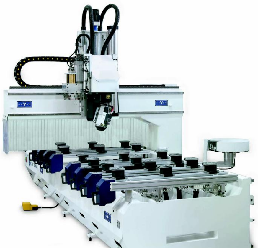
Piano i lavoro VCS con posaggio pezzo 350 mm utile lavorabile VCS working table with 350 mm working panel height
