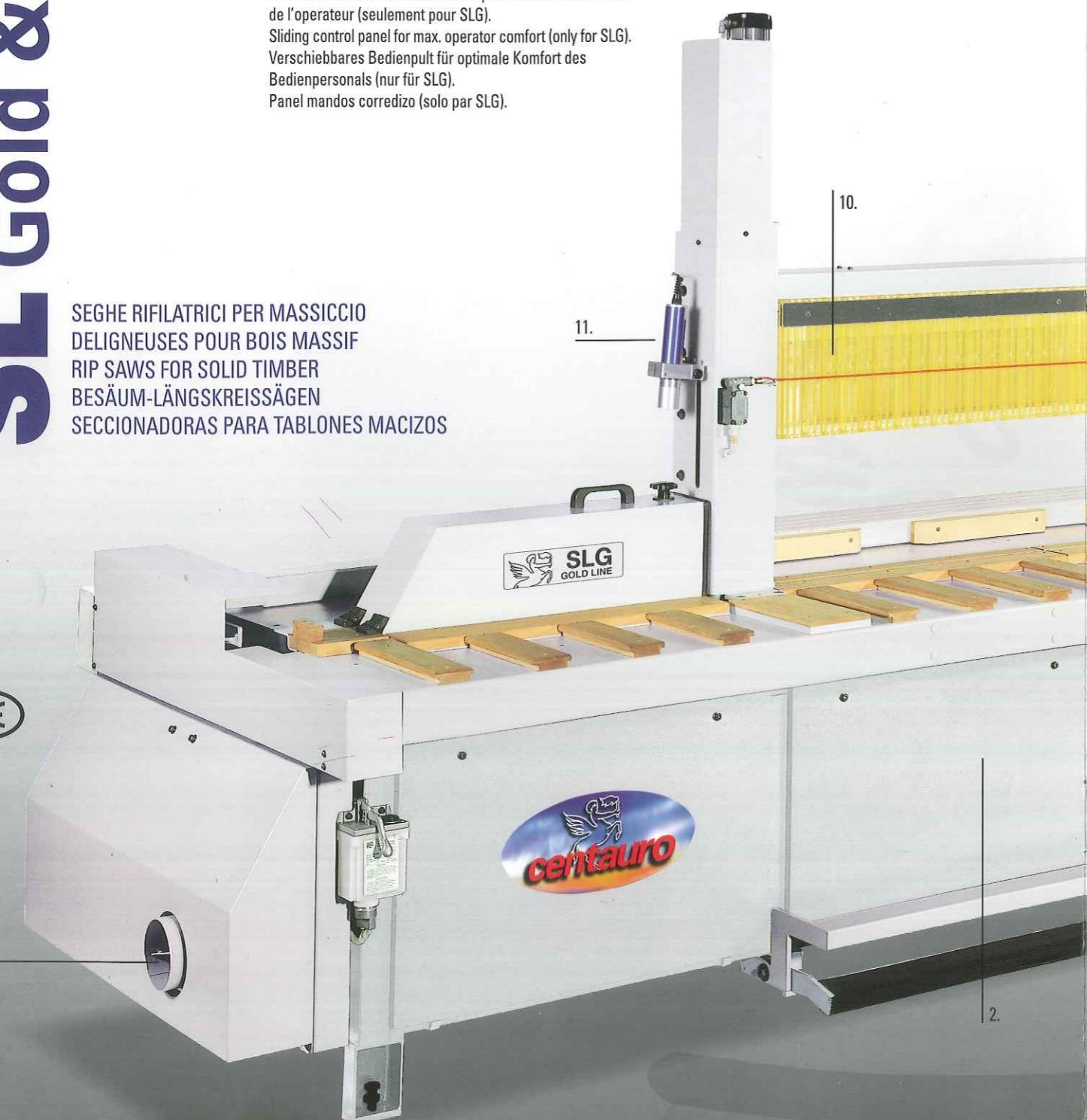
1. Bocca di aspirazione inferiore Ø 130 mm.
