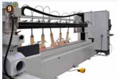
9 Dettaglio della postazione di carico/scarico manuale senza le protezioni di sicurezza. Details of the manual loading/unloading station without any safety protections.
