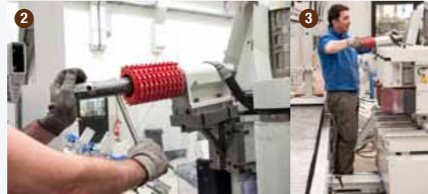
2 3 Un pratico corridoio consente il cambio degli utensili in modo rapido e comodo, garantendo l'accesso a tutti gli utensili dalla medesima posizione. A handy corridor enables changing the tools quickly and comfortably, ensuring access to all the tools from the same position.
