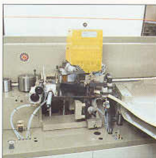
Gruppo incollaggio termofusibile per diritto Hot-melt glueing unit for straight Groupe encollage thermofusible pour chants droits Verleimteil für gerade Kanten mit Schmelzkleber Группа для термоплавкого склеивания прямых кромок
