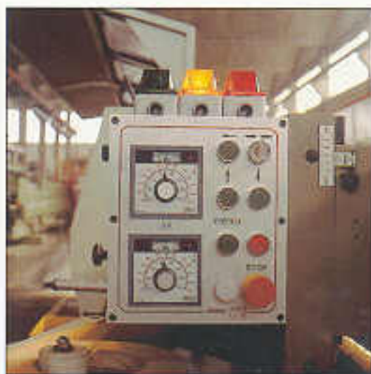
Termoregolatori per vaschetta colla e rullo colla. Thermoregulators for glue pot and spreading roller. Thermorégulateur pour bac à colle et rouleau colle. Thermoregler für Schmelzkleberbecken und Leimrolle. Терморегуляторы бака и роликов для клея
