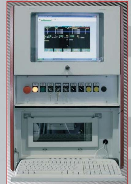
CNC con PC integrato e relativo sistema windows per consentire l'applicazione di un CAD-CAM direttamente a bordo della macchina. La gestione dei programmi di lavoro può avvenire tramite connessione ethernet.
