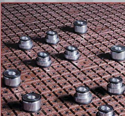
Esempio di posizionamento di ventose COSMEC ad innesto rapido
