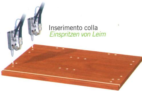
Il modulo colla è dotato di due iniettori indipendenti nei movimenti in Y e Z, alimentati da una pompa ad alta pressione. La quantità di colla inserita è dosata tramite CNC.
