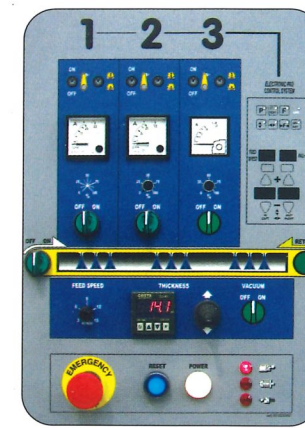
Pannello comandi intuitivo e completo, con led per segnalare i vari tipi di emergenza possibili.
