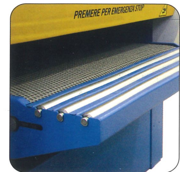
Rulliere folli poste in entrata ed uscita del banco avanzamento per aumentare la base d'appoggio dei pezzi
