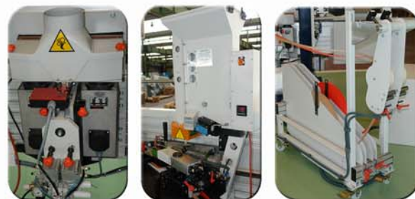
Vista de grupo repasador doble neumático, prefusor de cola y almacén doble rollo.
