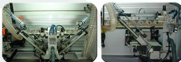
Grupo retestador V12/320 y retestador K12. Posicionamiento automático recto/bisel.
