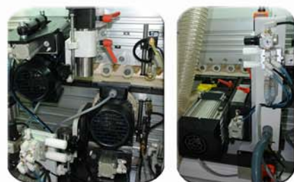
Líquido de limpieza, grupo maticantos oscilante y grupo ranurador neumático.
