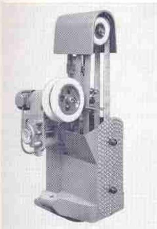
Automatische Doppelband-Rundstabschleifmaschine, Modell KED V/asd, mit zwei Schleifleinbändern verschiedener Körnung und zwei Gummitransporträdern, federnder Bandanlage und kugelgelagerten Laufrollen arbeitend, zum Schleifen zylindrischer, balliger, konischer und ovaler Teile beliebiger Länge verwendbar; mit zwei schaltbaren Vorschubdrehzahlen sowie stufenloser Vorschubregelung, starkem Antriebsmotor und sehr langen Schleifbändern
