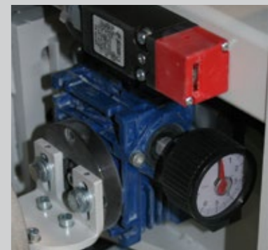
Mikrometer Feinjustellung für Schleifschuh-Position Ajuste de micrómetro para la posición de la almohadilla Микрометрическая регулировка рабочего положения утюжка
