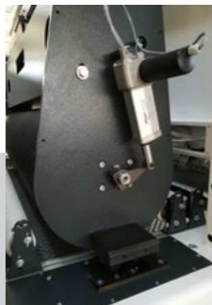
Elektronischer Körnungs-Ausgleich Grit-set electrónico Электронное устройство Grit-set для компенсации зернистости шлифленты
