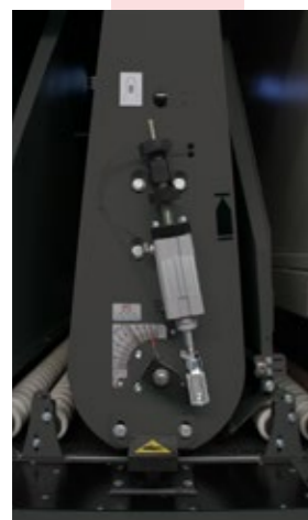
Elektronischer Körnungs-Ausgleich Grit-set electrónico Электронное устройство Grit-set для компенсации зернистости шлифленты
