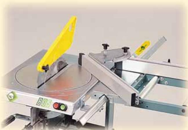
**Winkelanschlag für schräges Querschneiden breiter Platten/Paneele**
