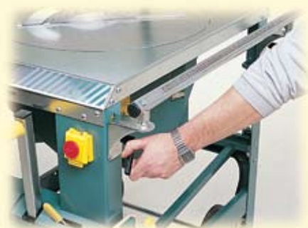
Styreskinne med hurtigkobling
